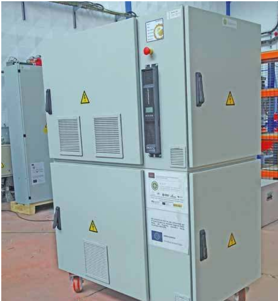
Convertidor para baterías de almacenamiento en Smart Grids, desarrollado por ELINSA.
